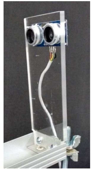
Figura 47: Suporte do sensor instalado.
