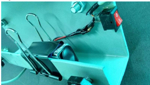
Figura 22: Circuito de alimentação do laser.
